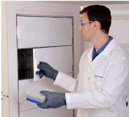
Новые магнитные затворы на внутренних дверцах облегчают доступ к пробам 1)
