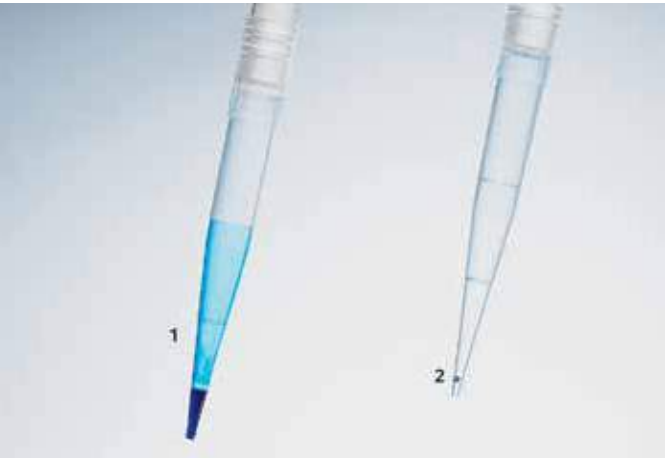
“Pearl Effect” — сравнение объемов остаточной жидкости при пипетировании растворов, содержащих детергенты: 1. Значительная потеря пробы в обычном наконечнике 2. Максимальное извлечение с epT.I.P.S. LoRetention
