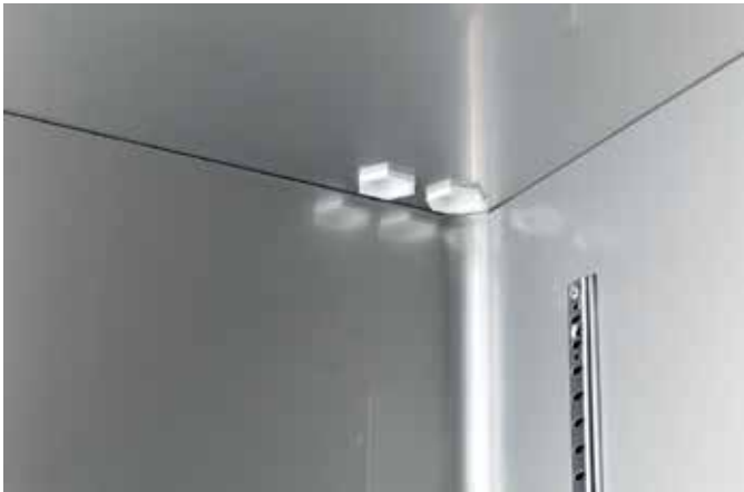
Два порта доступа позволяют вводить CO 2 /LN 2 или вставлять дополнительные датчики
