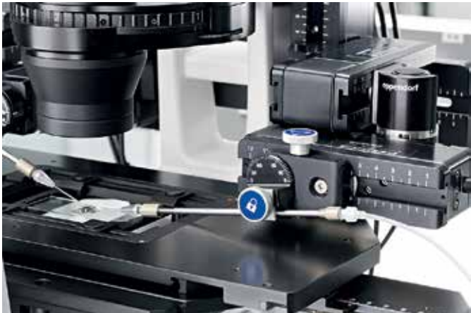
Легкоустанавливаемый рабочий угол может регулироваться от 0° до 90°
